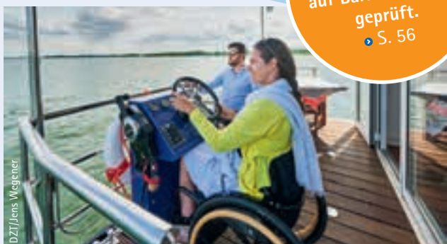
Der Steuerstand ist unterfahrbar.
